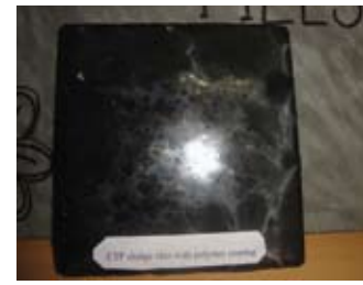
ETP sludge ব্যবহার করে poly tiles তৈরি
